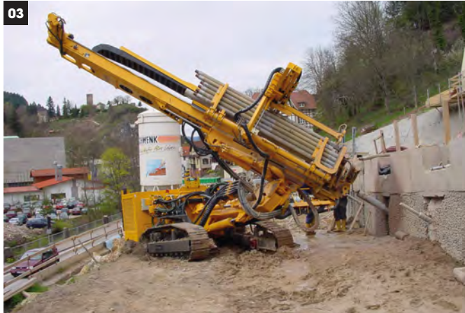
01 MAG 7.0 für KR 807-7G // for KR 807-7G 02 Einhebevorrichtung HBR 200 // Rod handling device HBR 200 03 MAG 2.1V für KR 806-3D // for KR 806-3D 04 MAG 1.2 für KR 806-2DB // for KR 806-2DB 05 HBR 120 für Minibagger // for mini excavator
